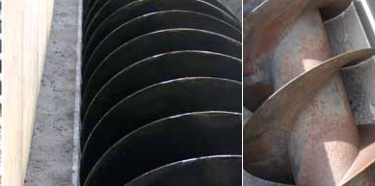
Schneckenrog mit Schmelzbasalt ausgekleidet
